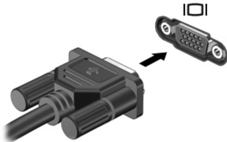
**附註：**如果已經正確連接的外接式顯示裝置沒有顯示影像，請按下 **fn+f4** 鍵將影像轉送到此裝置。重複按 **fn+f4** 鍵即可在電腦顯示器和裝置之間切換螢幕影像。
