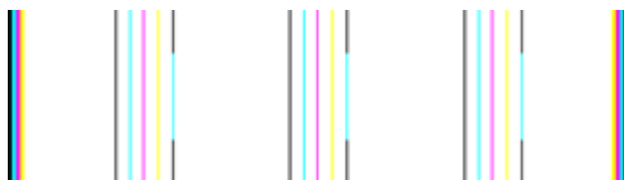
Esempio di un modello di allineamento buono Le righe sono dritte.
