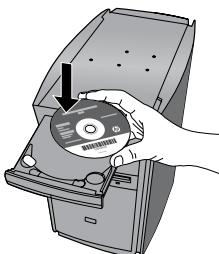
CD'yi taktığınızda, ekranda beliren animasyonlar mürekkep kartuşlarını takma ve kağıt yükleme aşamaları da dahil olmak üzere, yazıcı kurulumu boyunca sizi yönlendirecektir.
