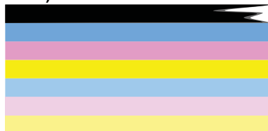
Slika 11-2 Trake boja – nepravilno isprugana ili izbljedjela traka (gornja traka)
