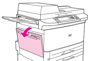
Figure 12-63 Supprimez les bourrages dans la trappe gauche (2 sur 4)
