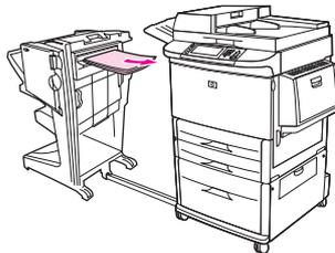
3. Öffnen Sie die hintere Klappe des Abschlussgeräts. Wenn das im Abschlussgerät eingeklemmte Papier noch nicht die Faltwalzen erreicht hat, ziehen Sie es vorsichtig heraus, und fahren Sie mit Schritt 7 fort. Hat das Papier bereits die Faltwalzen erreicht, machen Sie mit Schritt 4 weiter.
