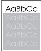
Wenn ein Druckbild, das oben auf der Seite in kräftigem Schwarz ausgegeben wird, weiter unten auf der Seite in einem grauen Feld wiederholt wird, konnte der Toner des letzten Druckauftrags möglicherweise nicht vollständig gelöscht werden. Die Wiederholung kann heller oder dunkler als das umgebende Feld sein.
