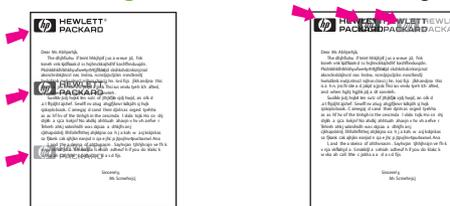
Dieser Fehler tritt u. U. beim Drucken von vorgedruckten Formularen oder einer großen Menge von schmalen Medien auf.
