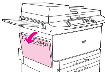
3. Entfernen Sie eingeklemmte oder beschädigte Druckmedien aus diesem Bereich, indem Sie diese aus dem MFP-Gerät ziehen.
