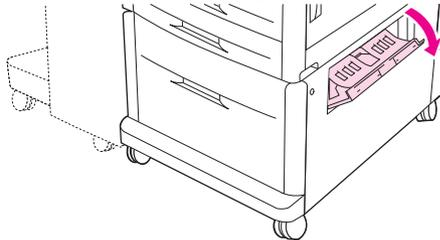
2. Überprüfen Sie, ob sich Papier in diesem Bereich befindet, und entfernen Sie es gegebenenfalls. Achten Sie sorgfältig darauf, dass sämtliche Papierreste entfernt werden.
