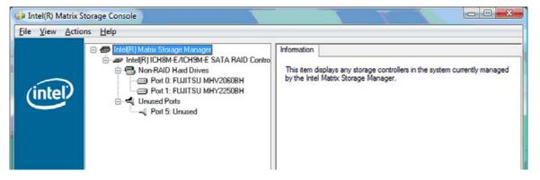
En mode avancé, la console inclut également le menu d'actions, qui permet d'accéder aux options RAID avancées pour la configuration manuelle d'un volume RAID ou de restauration.
