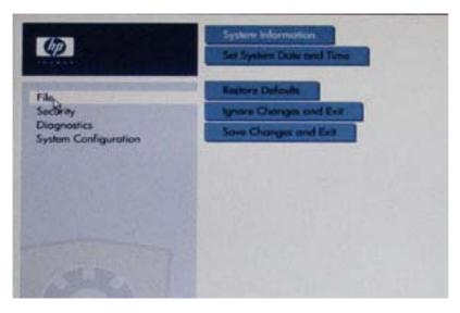
Dans le BIOS système, sélectionnez Configuration du système > Configurations des périphériques.
