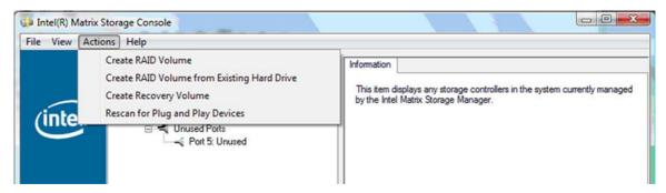
3. La sélection d'une option d'action ouvre l'assistant de création du volume de restauration, qui vous permet de sélectionner le disque principal et le disque secondaire (restauration). Pour plus d'informations, sélectionnez Help (Aide) > Contents and Index (Contenu et index) ou appuyez sur f1.
