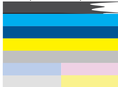
Abbildung 12-2 Farbbalken - unregelmäßige Streifen oder ausgeblancheter Balken (oberer Balken)
