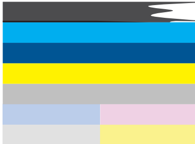
図 12-2 カラー バー - 不規則な縞模様またはかすれ (一番上のバー)
