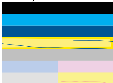
Bild 12-3 Färgfält - färgblandning (gula fält innehåller magentafärgade strimor)
