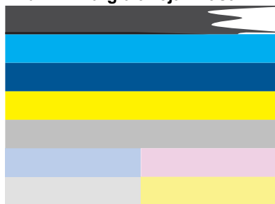
Bild 12-3 Färgfält - färgblandning (gula fält innehåller magentafärgade strimor)
