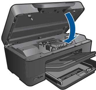
**Causa:** El cabezal de impresión o los cartuchos de tinta no estaban instalados o estaban instalados incorrectamente.
