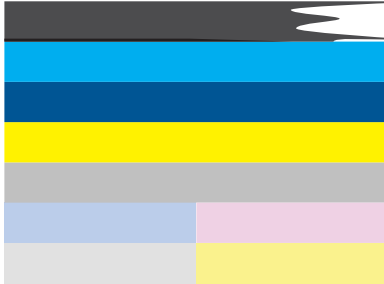
Figure 11-2 Barres de couleur : barre irrégulière ou teinte délavée (barre du haut)
