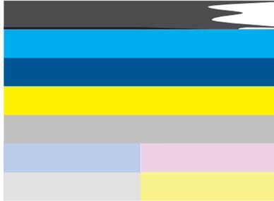
**Figura 11-3 Barre di colore: mescolamento del colore (la barra gialla contiene striature magenta)**
