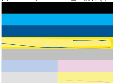
図 11-3 カラー バー - 色の混合 (イエロー バーにマゼンタの縞模様が含まれる)
