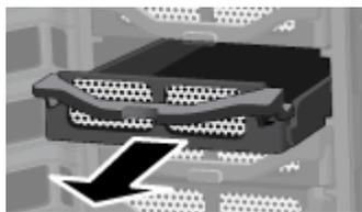
6. Biegen Sie die rechte Seitenschiene im hinteren Bereich, um den hinteren Stift aus der Festplatte zu lösen, indem Sie die Seitenschiene vorsichtig nach unten vom Laufwerk weg ziehen.
