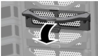
11. Schließen Sie die Klappe an der Vorderseite des Servers.
