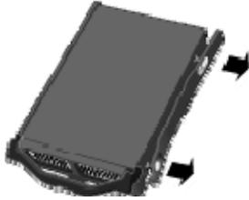
7. Biegen Sie die rechte Seitenschiene im vorderen Bereich, um den vorderen Stift aus der Festplatte zu lösen, indem Sie die Seitenschiene vorsichtig nach unten vom Laufwerk weg ziehen.
