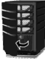
3. Drücken Sie am ersten freien Festplatteneinsatz von unten den Hebel nach unten, um den Griff zu entriegeln.
