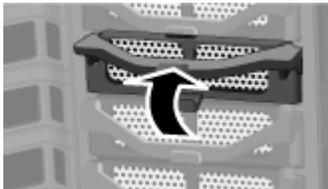
6. Ziehen Sie das Systemlaufwerk vorsichtig aus dem Laufwerkseinschub.
