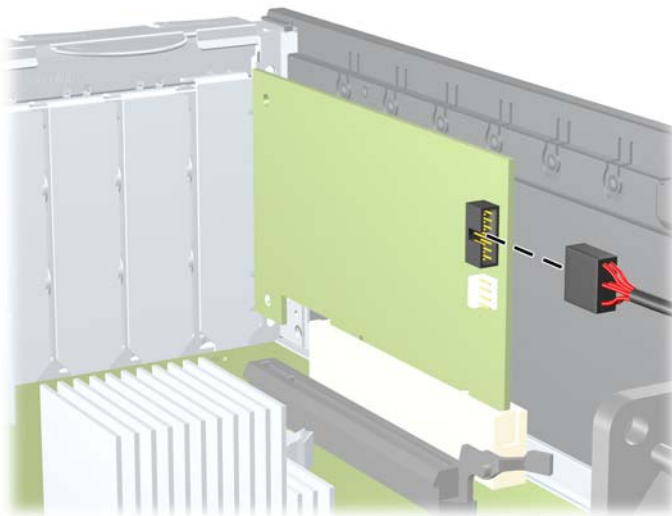
Фигура 2-30 Изваждане на кабела 1394 на четеца за медийни карти
