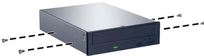
8. Deslize a unidade para dentro do compartimento, assegurando-se de alinhar os parafusos-guia com os slots, até a unidade encaixar-se em seu lugar.
