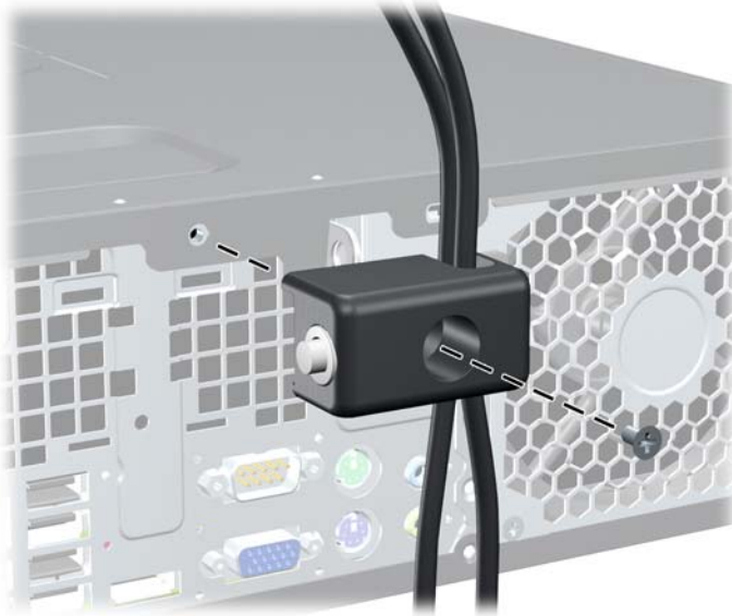
Obrázek C-5 Přichycení zámku ke skříni
