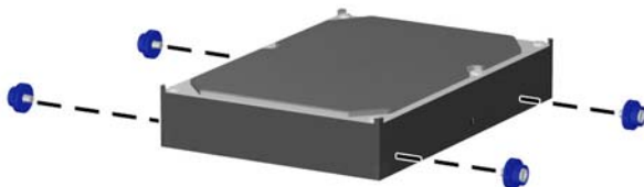
Obrázek 2-37 Montáž vodicích šroubů pevného disku
