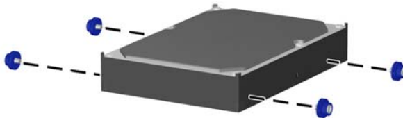
Kuva 2-37 Kiintolevyn ohjainruuvien asentaminen
