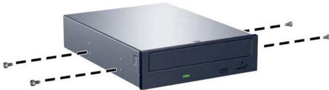
Figure 2-23 Installation des vis de guidage (unité optique illustrée)
