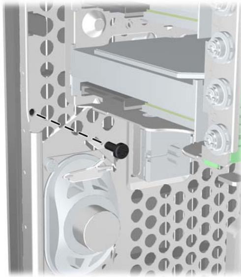
Figure C-8 Installation de la vis de sécurité du cache avant
