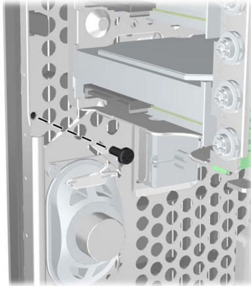
Εικόνα Γ-8 Τοποθέτηση βίδας ασφαλείας της πρόσοψης
