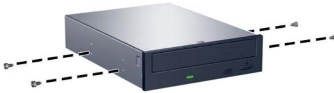
9. Setzen Sie das Laufwerk mit den Führungsschrauben in die J-förmigen Schlitz im Laufwerksschacht ein. Schieben Sie das Laufwerk dann nach vorne, bis es einrastet.
