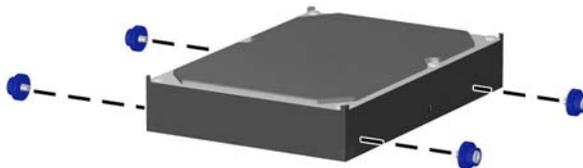
12. Richten Sie die Führungsschrauben an den Steckplätzen am Laufwerksgehäuse aus, drücken Sie das Laufwerk nach unten in den Schacht hinein, und schieben Sie es so weit wie möglich nach hinten, bis es einrastet.
