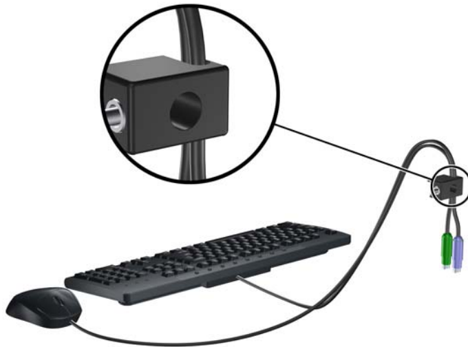
Slika C-4 Povezivanje kabela tipkovnice i miša
