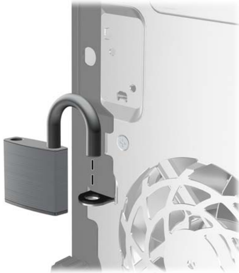
Slika C-2 Ugrađivanje sigurnosnog lokota
