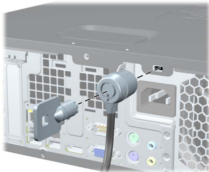
Slika C-1 Ugradnja sigurnosnog kabela
