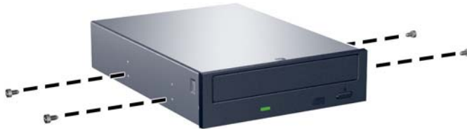
Slika 2-24 Ugradnja vijaka za vođenje u optički pogon
