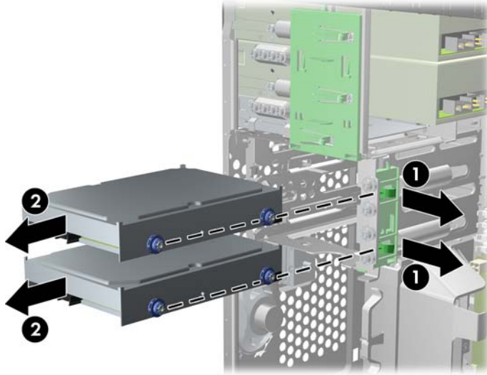
2-29 ábra A merevlemez-meghajtó eltávolítása
