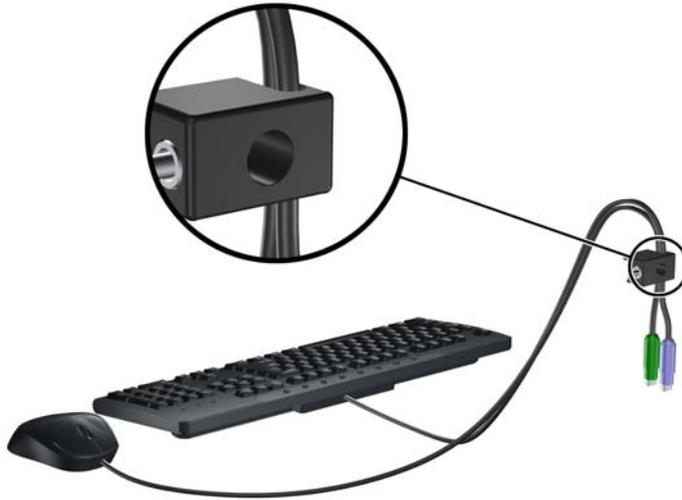
3. Avvitare il fermo allo chassis mediante la vite fornita.
