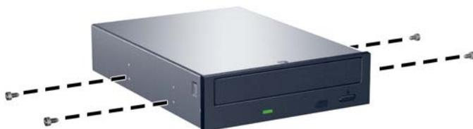
8. Infilare l'unità nell'alloggiamento, allineando le viti ai fori, fino a che non si blocca.
