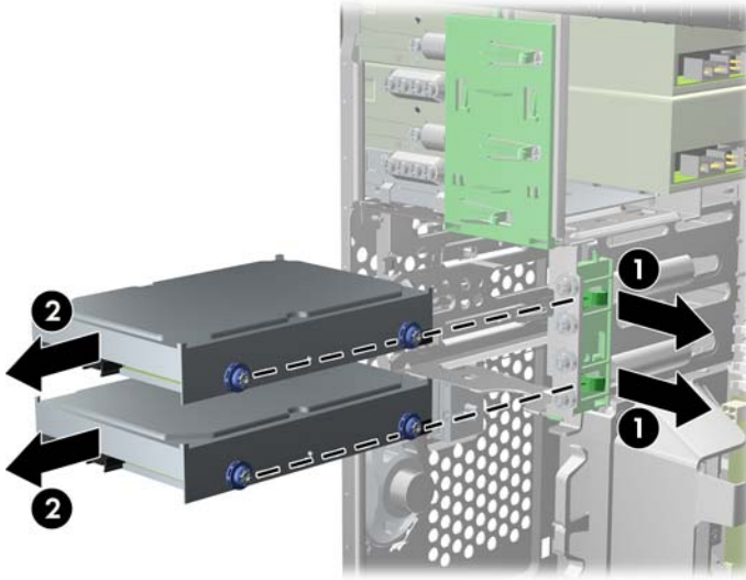
図 2-29 ハードディスク ドライブの取り外し
