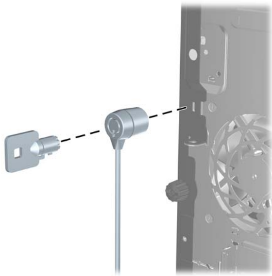
図 C-1 ロック ケーブルの取り付け
