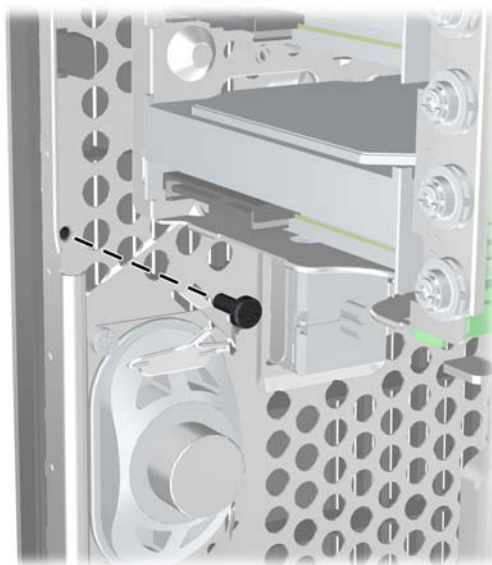
図 C-8 フロント パネルのセキュリティ ネジの取り付け
