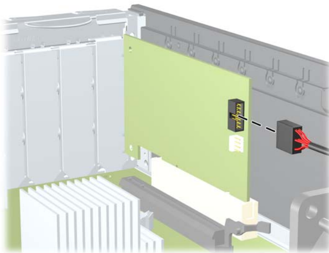
図 2-30 メディアカードリーダーの 1394 ケーブルの取り外し
