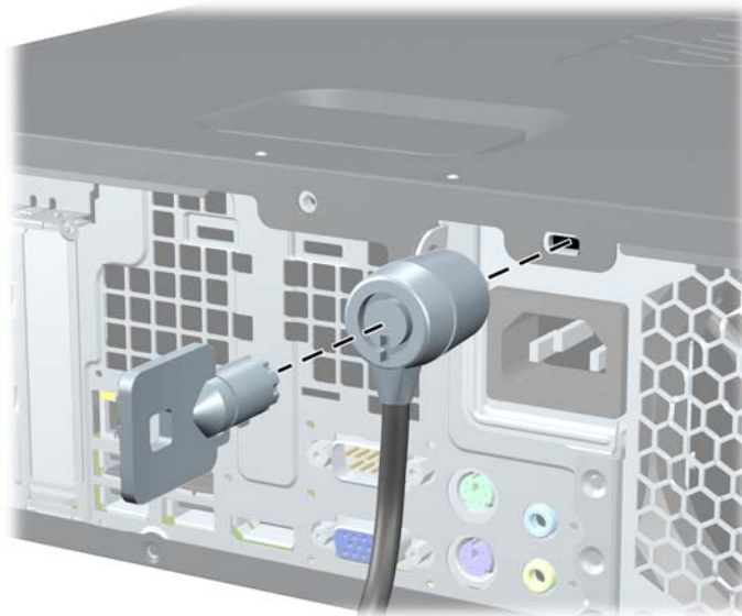
図 C-1 ロック ケーブルの取り付け
