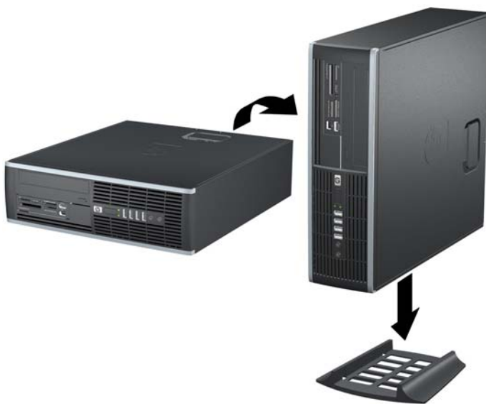
図 2-6 横置きから縦置きへの移行
