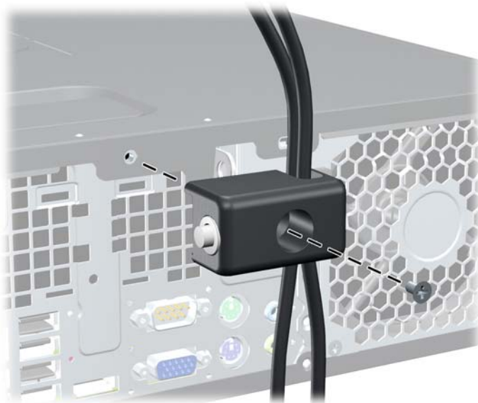
図 C-5 シャーシへの錠の取り付け
