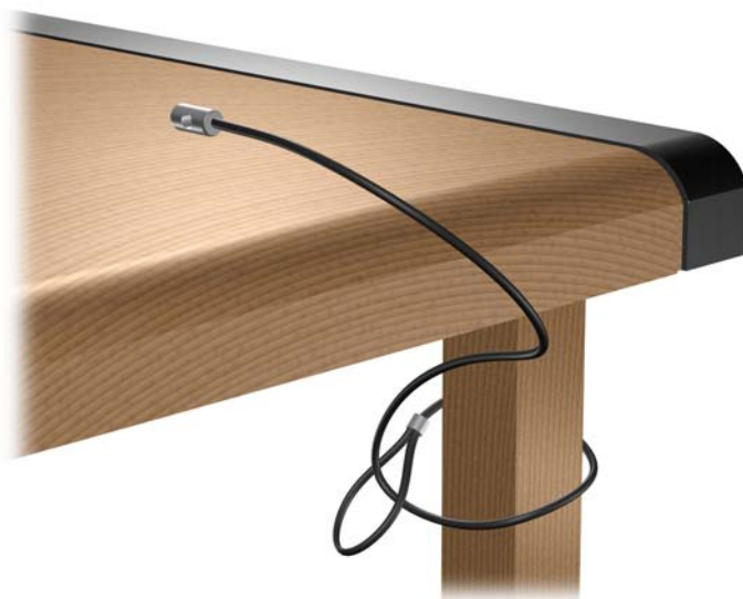
図 C-3 ケーブルの固定物への固定
