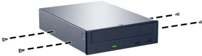
그림 2-24 광 드라이브에 유도 나사 설치
