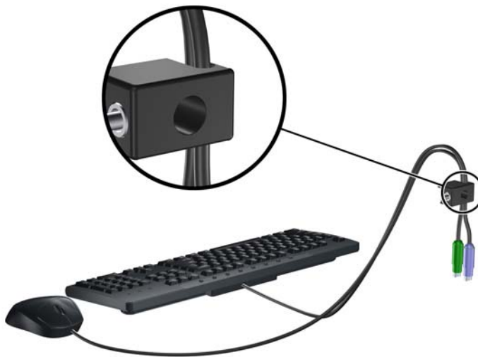
그림 C-4 키보드 및 마우스 케이블 모아 넣기
