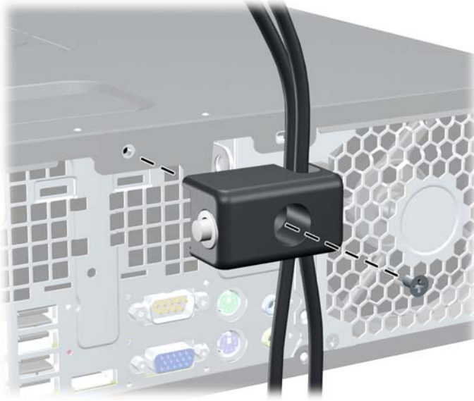
그림 C-5 새시에 잠금 장치 부착
