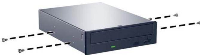
8. Deslice la unidad en el compartimiento, asegurándose de alinear los tornillos guía con las ranuras guía, hasta que la unidad se encaje correctamente.
