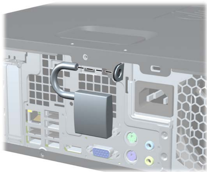
Figura C-2 Instalación de un candado
