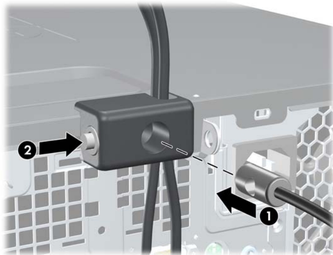
Figura C-6 Activación del Bloqueo
