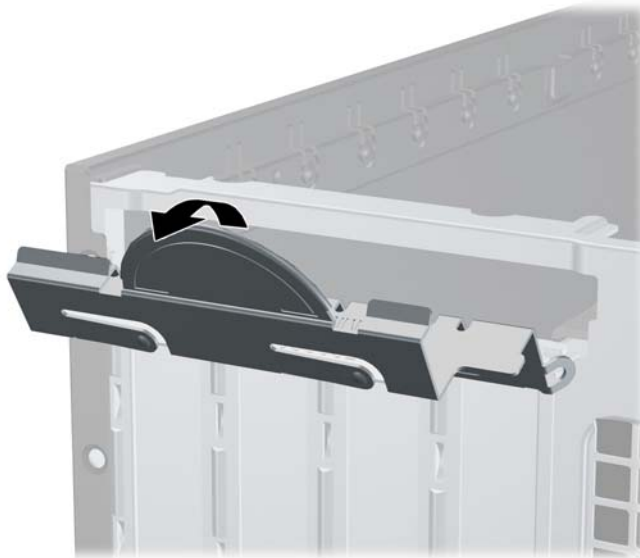
Afbeelding 2-11 Borgbeugel voor uitbreidingskaarten openen
