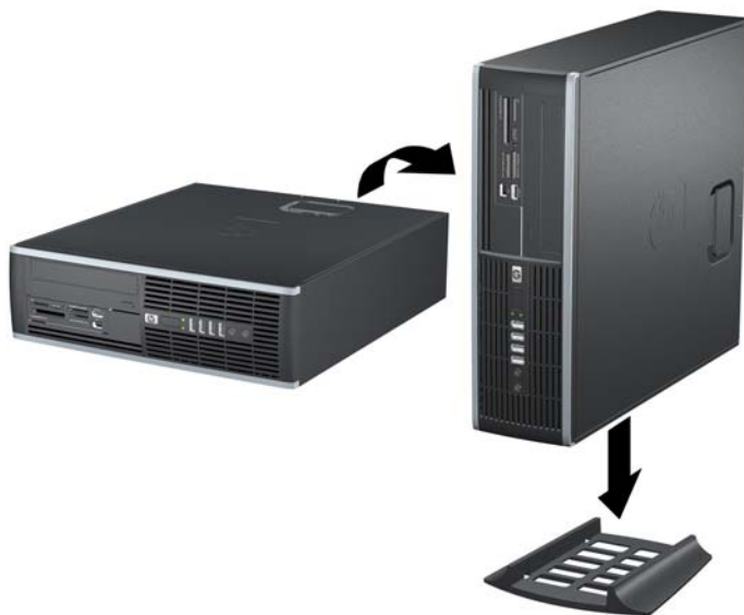
Afbeelding 2-6 Desktopconfiguratie omzetten in torenconfiguratie
