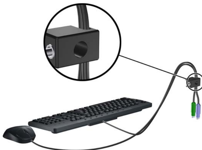
Afbeelding C-4 Toetsenbordkabel en muiskabel door het slot voeren
