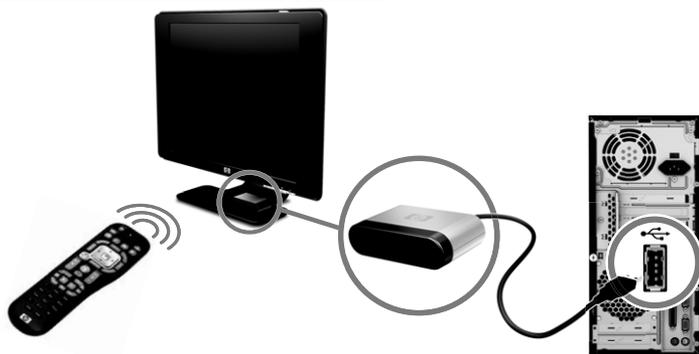
Para usar o controle remoto, aponte-o em uma linha direta de visão para o sensor remoto. O controle remoto e o sensor devem estar em uma distância de até 8 metros. O controle remoto deve estar em um ângulo máximo de 22,5 graus (total de 45 graus) do centro do sensor remoto.
