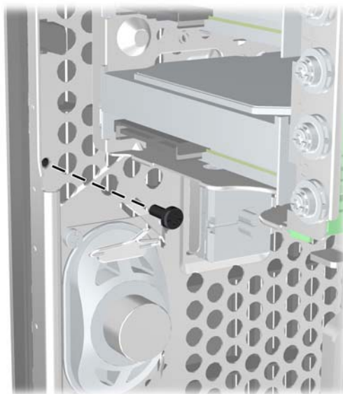
Obrázok C-8 Inštalácia bezpečnostnej skrutky predného panela
