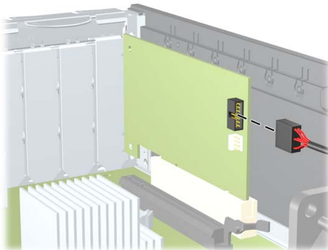
Obrázok 2-30 Odpojenie kábla 1394 čítača mediálnych kariet
