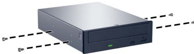
Figura 2-23 Instalación de los tornillos de guía (se muestra unidad óptica)
