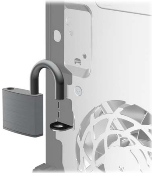
Figura C-2 Instalación de un candado
