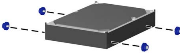
Şekil 2-37 Sabit Sürücü Kılavuz Vidaları Takma
