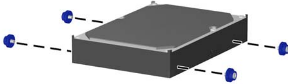
圖示 2-30 安裝硬碟機導引|螺絲
