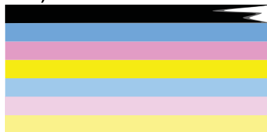
Figure 10-2 Barres de couleur : barre irrégulière ou teinte délavée (barre du haut)
