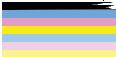
Joonis 10-2 Värviribad - korrapäratult joondatud või tuhm riba (ülemine riba)
