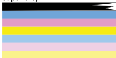
Figura 10-2 Barre di colore - striate in modo irregolare o sbiadite (barra superiore)
