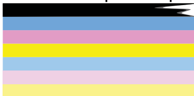
Slika 10-2 Barvni pasovi - nepravilno progasti ali zbledeli (zgornji pas)
