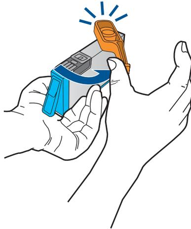
c. 比较颜色图标，然后将墨盒向插槽内滑动，直到碰触到位。
