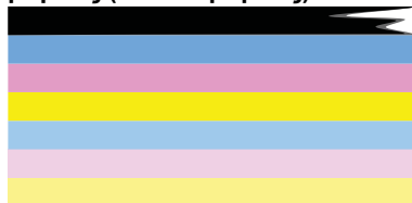
Εικόνα 11-2 Έγχρωμες ράβδοι - ακανόνιστες ραβδώσεις ή ξεθωριασμένη ράβδος (επάνω ράβδος)
