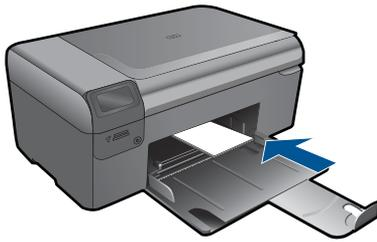
3. Deslice la guía de ancho del papel hacia adentro hasta que entre en contacto con el borde del papel.
