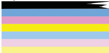
Figura 11-2 Bare de culoare - bară pătată neregulat sau estompată (bara de sus)
