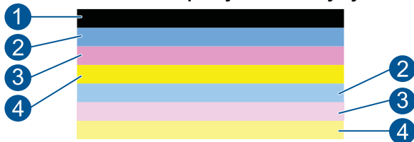
Obrázok 11-1 Farebné pruhy - očakávaný výsledok
