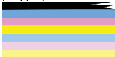
Obrázok 11-2 Farebné pruhy - nepravidelné prúžky alebo vyblednutý pruh (horný pruh)
