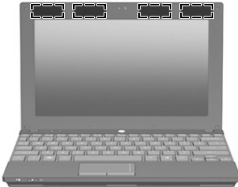
**HINWEIS:** Achten Sie im Sinne einer optimalen Übertragung darauf, dass sich keine Gegenstände in unmittelbarer Umgebung der WLAN- und WWAN-Antennen befinden.
