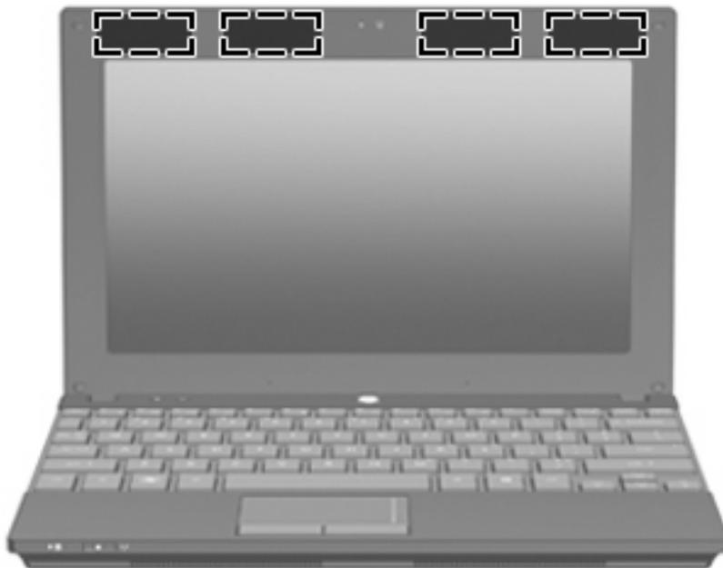
**注記：** 転送が最適に行われるようにするため、無線 LAN アンテナおよび無線 WAN アンテナの周囲には障害物を置かないでください。
