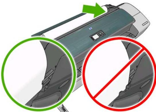
12. Coloque el papel en la impresora hasta que note resistencia y que el papel se dobla suavemente. Cuando la impresora detecta el papel, lo carga automáticamente.
